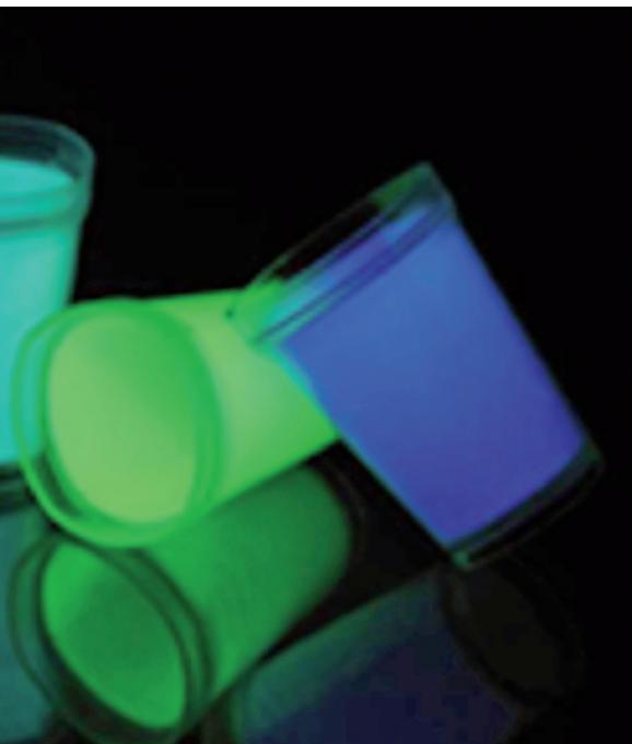
*L'impiego di pigmenti fosforescenti inorganici può generare interessi sia per la riduzione del riscaldamento dell'infisso, sia per i particolari effetti di rilascio della radiazione luminosa durante le ore notturne.*
